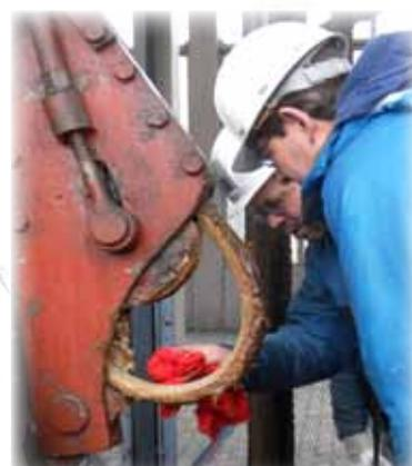
L'équipe d'AIB Vinçotte contrôle la partie du câble insérée dans la « crosse » et sa fixation.
